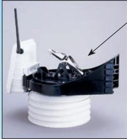
Konstruiert, um die Richtlinien der World Meteorological Organization (WMO) zu erfüllen, ist unser aluminiumbeschichteter **Verkippsbehälter** korrosionsbeständig und für eine hohe Genauigkeit laserkalibriert.
